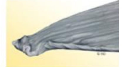
wiederverwendete Nadel 370-fach vergrößert
